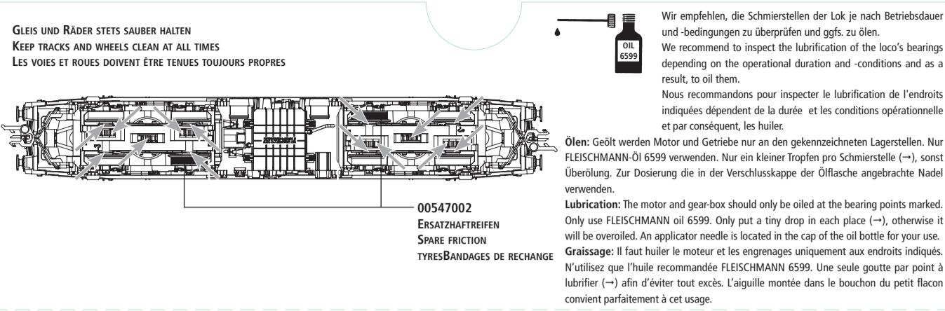
Reinigen der Lokräder: Bei Verschmutzung sind die Laufflächen der Räder mit sauberem Lappen oder Schieneneinigungsgummi 6595 zu reinigen. Niemals die angetriebenen Räder von Hand durchdrehen, sondern durch Anlegen einer Fahrspannung mittels Anschlussdrähten antreiben. Nichtangetriebene Räder können von Hand gedreht werden.
